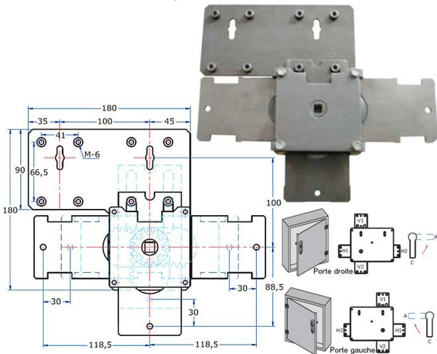
Mécanisme d'expansion pour verrouillage de coffre-fort, blocage par un verrou à gorge rectangulaire standard type AGA246, AGA247, etc.
